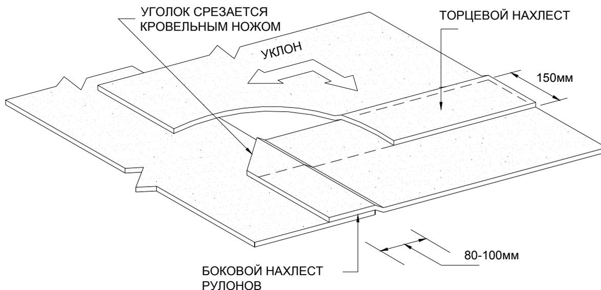
После удаления посыпки и подрезки уголка на место формирования торцевого нахлеста наносят слой битумно-полимерной мастики.
