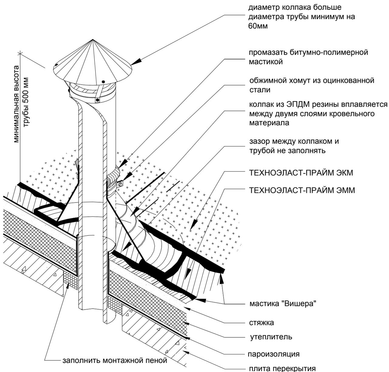
Фасонный резиновый элемент в месте пропуска трубы через кровлю устанавливается непосредственно на материал нижнего слоя кровельного покрытия на мастику «Вишера».
