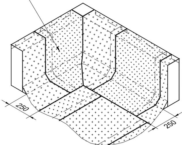
В углу материал Техноэласт-Прайм ЭКМ, укладываемый на парапет, обрезают кровельным ножом по месту.
