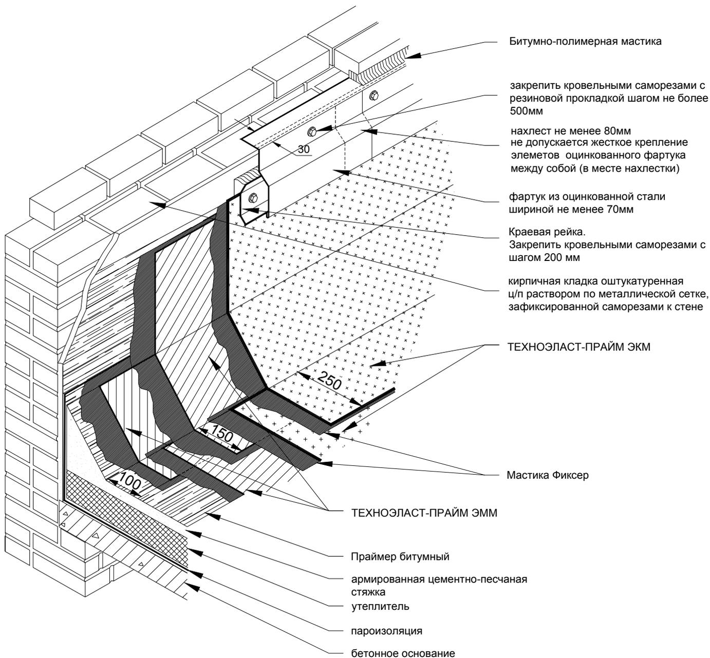
В случаях, если кровельный ковер примыкает к вертикальной стене здания, его заводят на вертикальную поверхность не менее чем на 300мм и фиксируют к основанию. Фиксация кровельного ковра на вертикальной стене может производиться с помощью краевой рейки. Особенности укладки материала полностью аналогичны описанным в предыдущем пункте. Рейку крепят кровельными саморезами с помощью электрошуруповерта. Верхний отгиб краевой рейки заполняют герметизирующей мастикой «Вишера».
