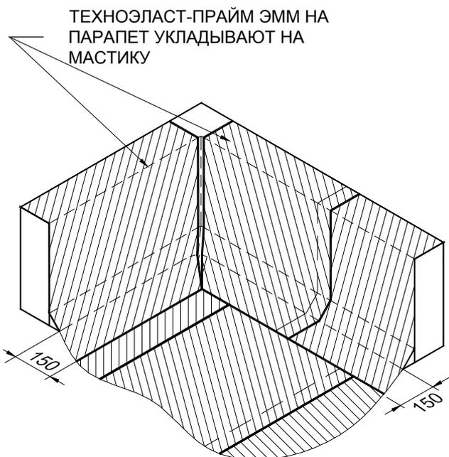
Все места нахлестов в обязательном порядке прикатывают силиконовым роликом. Материал первого слоя наклеивают на парапет на мастику. Материал должен заходить на 150 мм на горизонтальную часть основания. Точную подгонку материала производят при наклейке материала – по месту.
