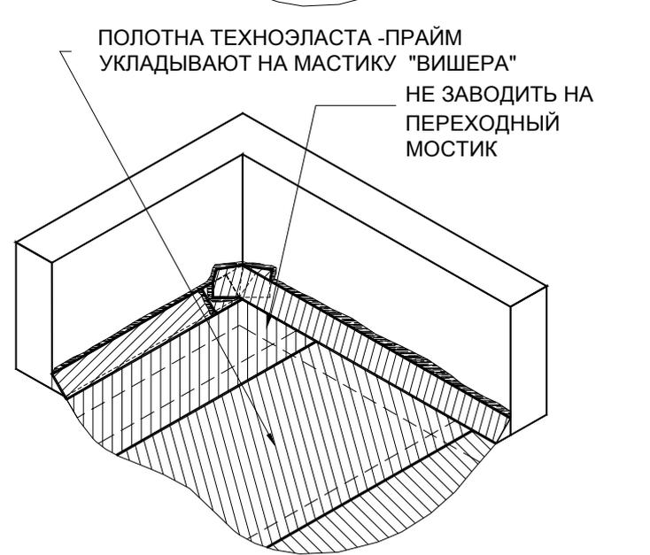
При укладке первого слоя материала на основании, края материала Техноэласт-Прайм ЭММ подводят к переходному бортику. Ближний к парапетной стене рулон кровельного материала при необходимости режут вдоль полотна так, чтобы край рулона вплотную примыкал к переходному бортику.
