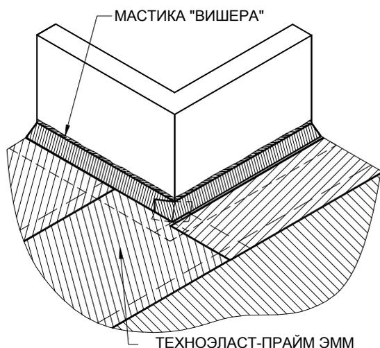
Материал первого слоя кровельного ковра подводят к переходному бортику. Ближний к парапетной стене рулон кровельного материала при необходимости режут вдоль полотна так, чтобы край рулона вплотную примыкал к переходному бортику.
