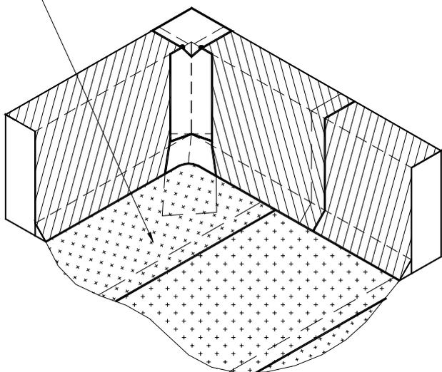
Материал верхнего слоя кровельного ковра Техноэласт-Прайм ЭКМ вплотную подводят к переходному наклонному бортику. Укладку материала осуществляют на мастику «Вишера». Все места нахлестов прокатывают роликами.
