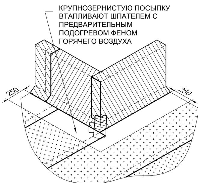
Места примыканий выполняют также с втапливанием крупнозернистой посыпки, однако расстояние от переходного бортика составляет 250 мм (ширина нахлестки материала на горизонтальную плоскость).
