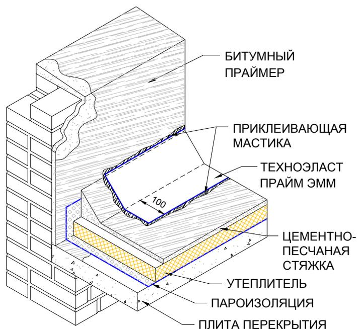
5.11.1. Приклеивающую мастику наносят в месте приклейки на оштукатуренное основание с помощью зубчатого шпателя. Мастику намазывают на переходный бортик и 100 мм горизонтальной поверхности у примыкания. На приклеиваемый материал мастику не наносят.
