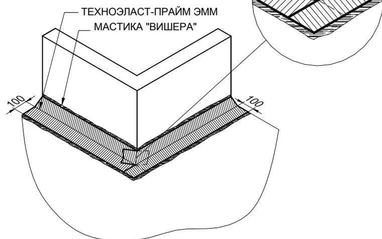
При формировании мест усиления, непосредственно в углу кровли материал разрезают и устраивают перехлест материала.
