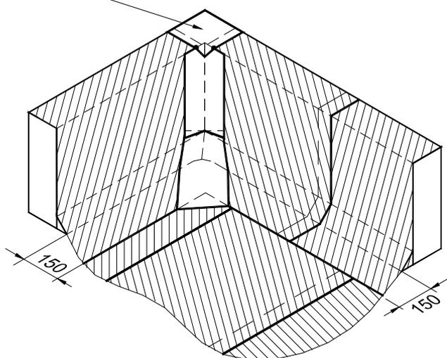
Сверху угол парапетной стены также закрывают куском материала. Язычок куска усиления необходимо прогреть феном и прижать к основанию.
